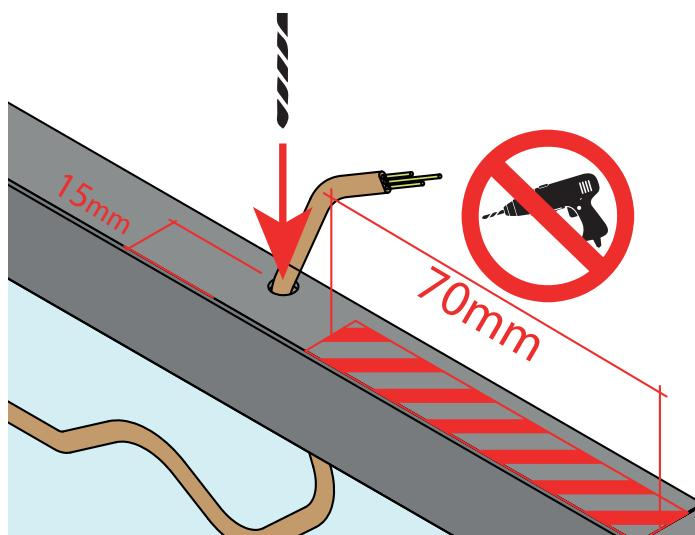
3 - Distanza minima da angolo per fissaggio lampade
