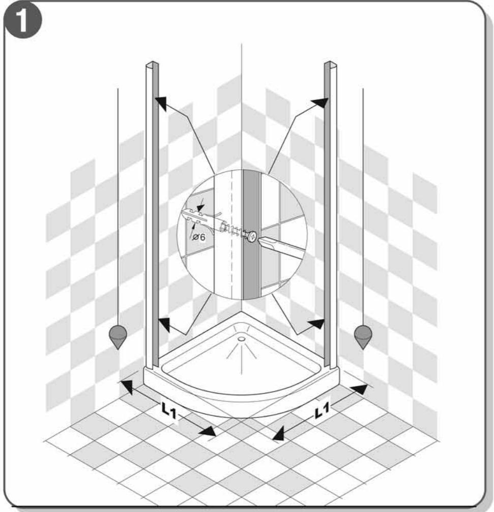
Togliere i due compensatori del box doccia e posizionarli a circa 1 cm dal bordo esterno del piatto. Verificare la perpendicolarità degli stessi e segnare il centro del foro (due fori per ogni profilo compensatore). Forare con una punta Ø 6 e inserire i tasselli in nylon Ø 6.
