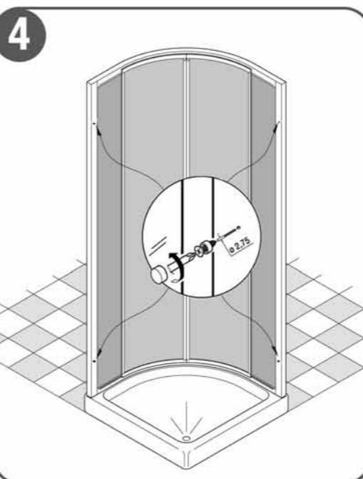
Controllare che la chiusura magnetica delle ante sia ottimale. Forare con punta Ø 2,75 e bloccarla con le viti 3,5 x 9,5 unitamente ai tappi copritive.
