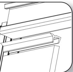
Beide Ausgleichsprofile der Falltür nehmen, sie ca. 1 cm. vom Außenrand positionieren und auf senkrechte Stellung prüfen. Auf der Fliese die Bohrungsmittle anzeichnen.
