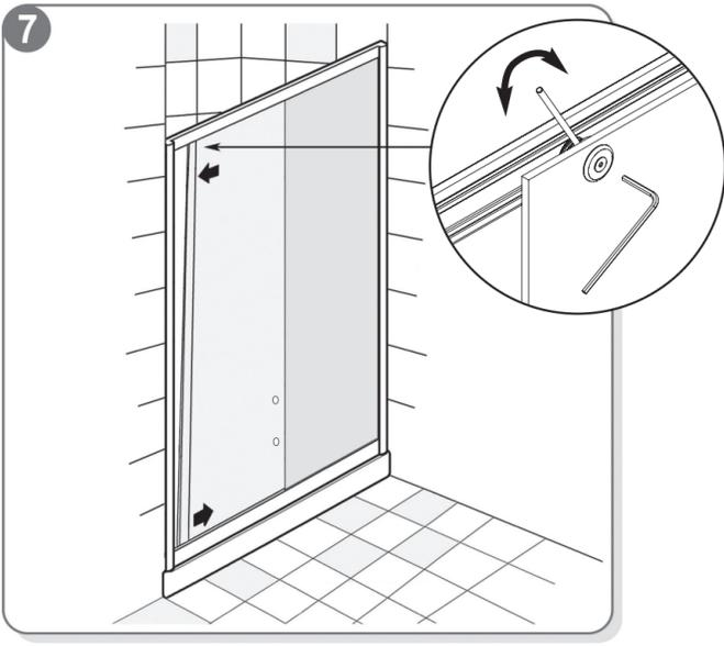
In caso di un impreciso allineamento delle due ante, allentare le vite della ruota superiore, regolare il fuori squadra dell'anta e serrare saldamente.
