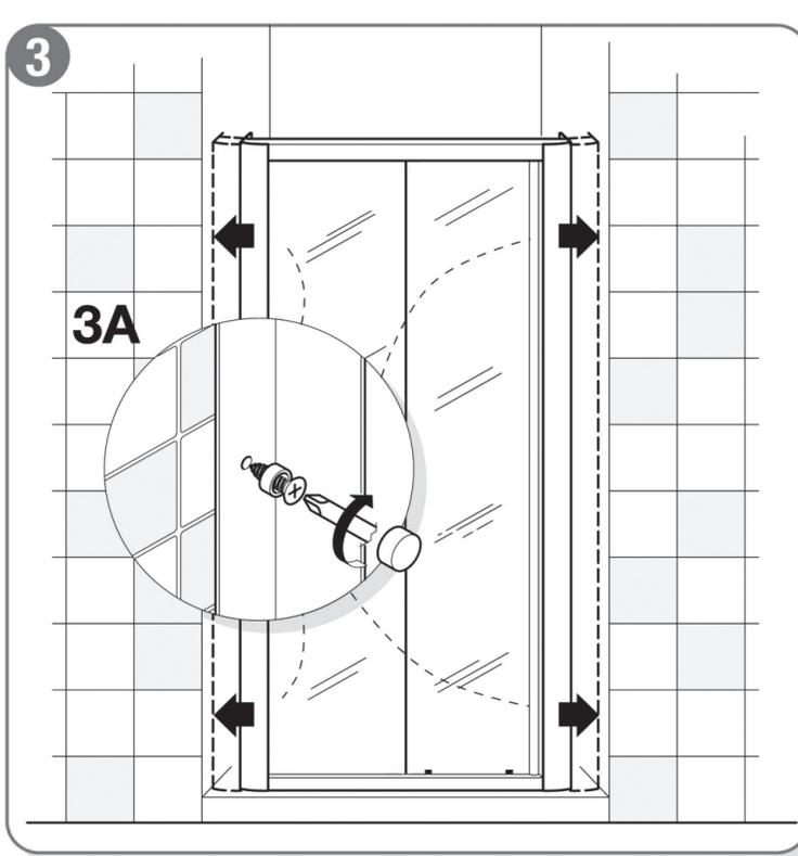
Decidete il senso di apertura (il box è reversibile) appoggiate il box doccia sul piatto con i compensatori inseriti, facendoli aderire lentamente al muro.
