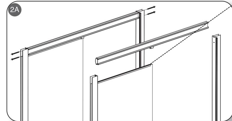
Assemblare i profili "binari" e le guarnizioni come da figura. Serrare gli stessi al profilo verticale con le viti 2 (Ø3,5x19mm).
