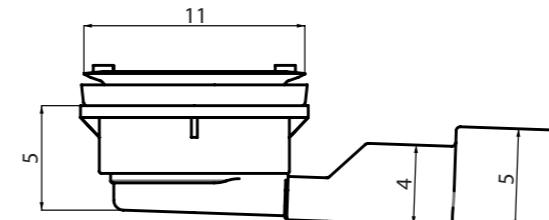
piletta di scarico standard INCLUSA H 50 mm
