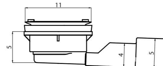
piletta di scarico standard INCLUSA H50 mm
