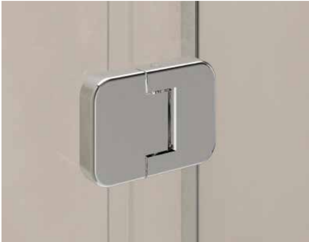
charnière en zamak chromé avec butée d'ouverture et de fermeture double joint à ailettes plié à chaud en un seul bloc
